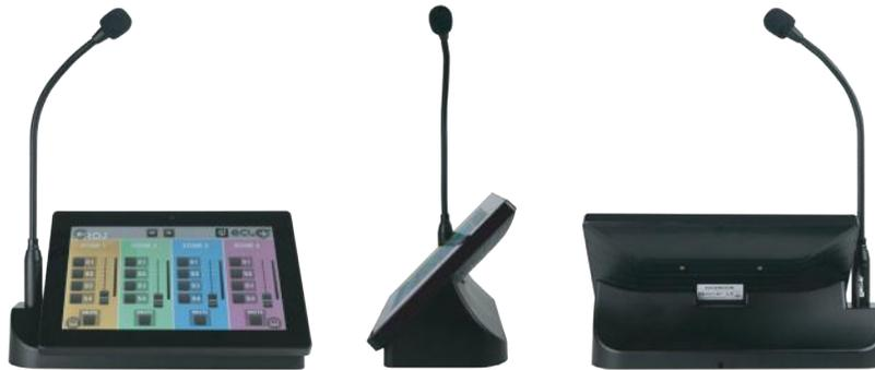
PAGENETDN 是款带 Dante( 音频网络 ) 的桌面寻呼控制台, 它与 MIMO4040DN 矩阵配合使用可以完美地管理大型的分区项目。它具有一个 10 " 的触摸屏, 集成 UCP( 用户控制软件 ) 客户端和服务端。PAGENETDN 可根据需要服务的目标区域的数量、分组、屏幕控制目的及美学等方面充分考虑为目标区域和呼叫范围提供服务。因为它是客户端 / 服务端设备, 它还可通过 TCP/UDP 协议连接其它外接设备进行控制, 如: 音量控制、声源选择、预设恢复等。电源供给有本地电源或 PoE 供电, 含鹅颈话筒。
