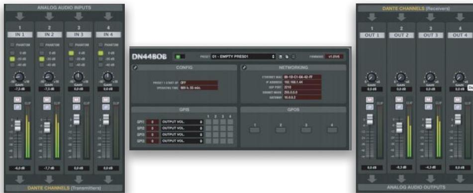
DN44BOB 是款 4 进 4 出的 DANTE: 接线盒, 它可将 4 个模拟音频信号转换为 4 个 DANTE 通道并发送到以太局域网里。同样, 它还可以将 4 个 DANTE 通道的信号转换为模拟音频信号。DN44BOB 含有 4 个 GPI 控制端口 (0-10VDC) 和 4 个 GPO 控制端口 (数控继电器)。它可以与含有 Ecler Net DANTE 的产品配套使用或作为一个独立的 DANTE 接口使用; 含有模拟音频输入或输出接口的音频设备均可配套使用。
